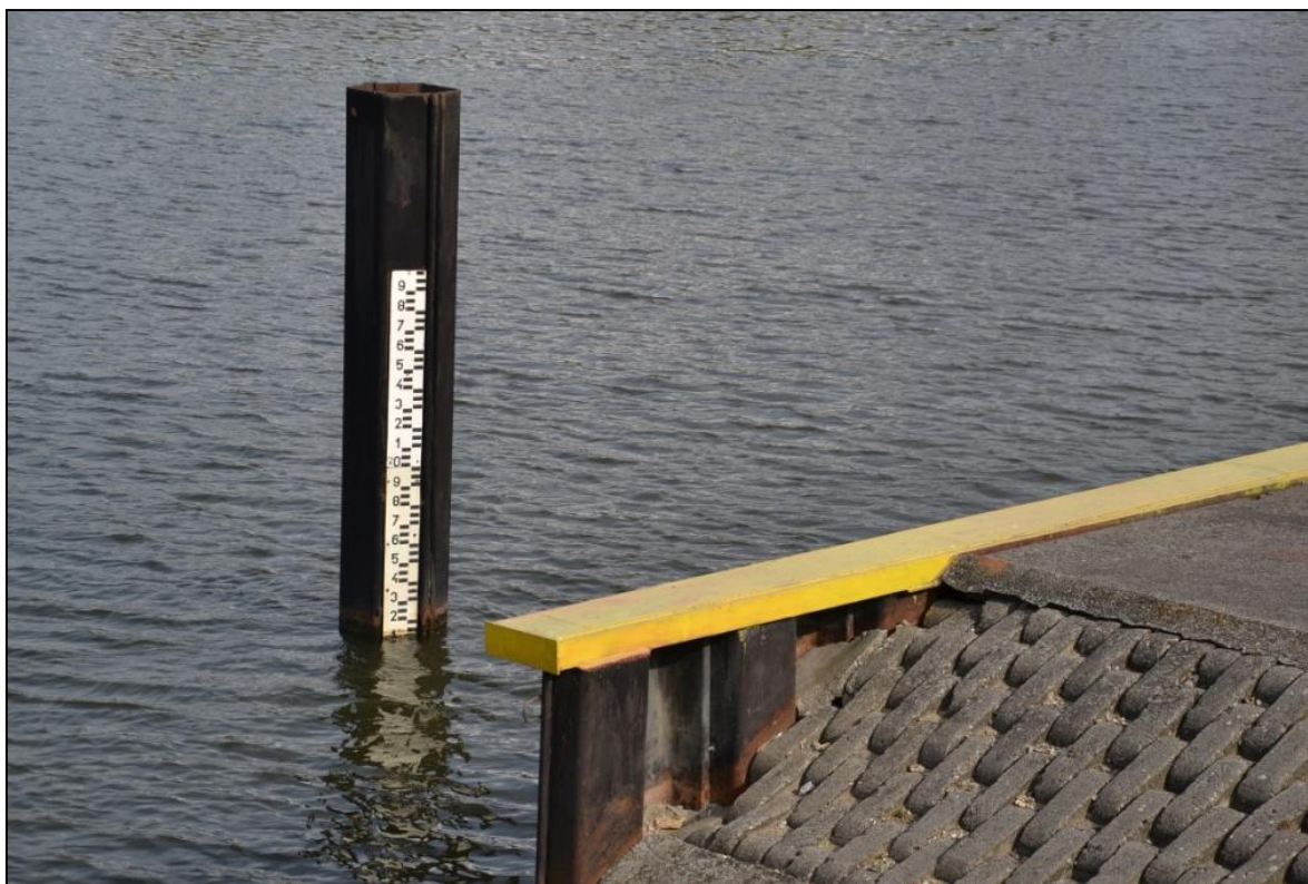
Rys.33. Przykładowa łata wodowskazowa zlokalizowana w awanporcie powyżej śluzy Januszkowice. Zdjęcie z dnia 20.04.2014
